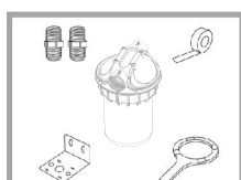
2 - Verifique quais os componentes que você necessita para a instalação. Utilize sempre fita veda rosca nas conexões. Indicamos o uso de um suporte para a instalação adequada do filtro. Obs: O uso do suporte é opcional e deve ser adquirido separadamente, se desejado.
