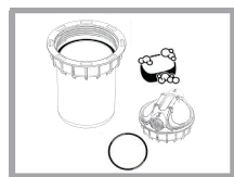
7 - Faça rotineiramente uma limpeza no copo, tampa e no anel o'ring do filtro. Utilize apenas água e sabão biodegradável. Evite materiais abrasivos. Não utilize álcool!
