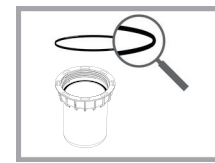
5 - Após a lavagem, verifique o estado de cada peça
